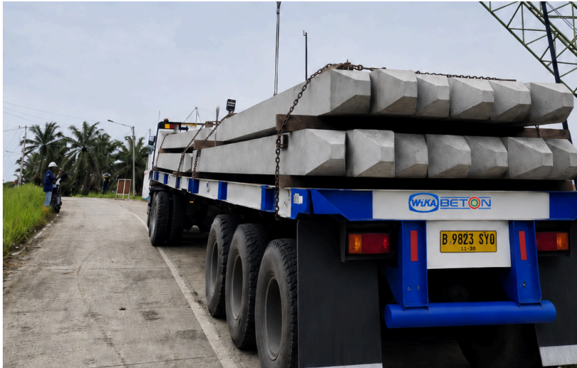
Tiang Pancang Kotak Wika Beton untuk Proyek Sekolah Rakyat
